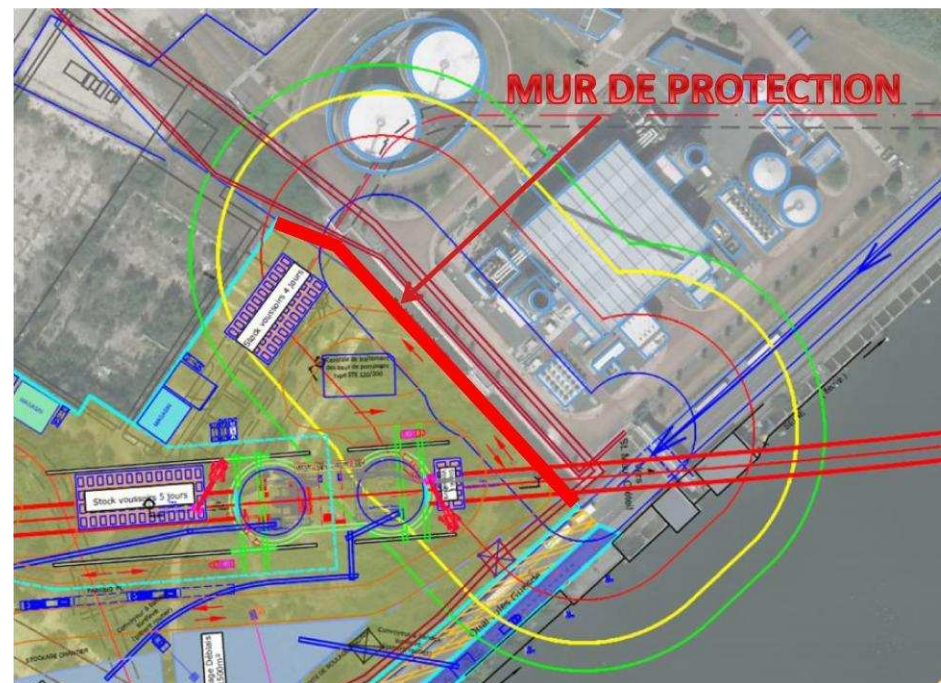
Mur de protection entre l'OA Friche Arrighi et le site Seveso Seuil bas EDF CETAC (source: Société du Grand Paris)
